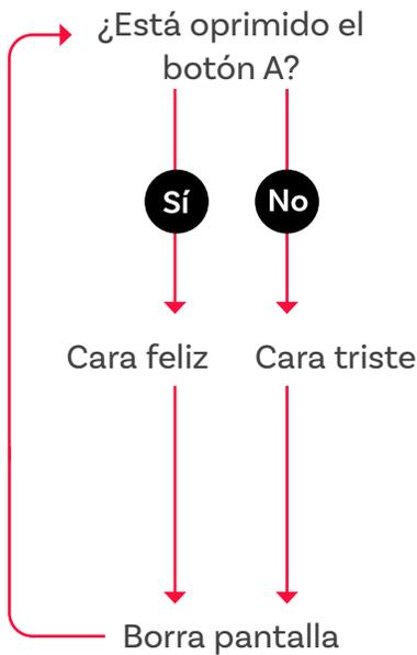
**Figura 1.** Código con condicional Si entonces, Si no.
