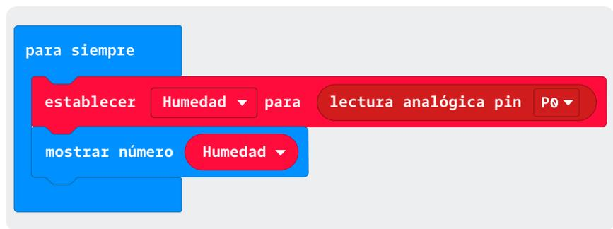
En la *micro:bit*, la lectura análoga de variables físicas permite captar las variaciones de la humedad de la tierra entre dos valores enteros: 0 cuando no hay humedad y hasta 1023 cuando la humedad presente sea la más alta que se pueda medir. De esta forma, no solo se sabrá si la tierra está húmeda o no, sino qué tan húmeda.
