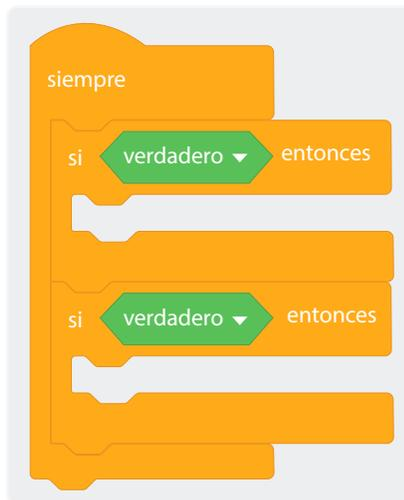
Luego de realizar las conexiones, vamos a programar lo necesario para que estos leds realicen su función. Para esto, debes agregar el bloque Siempre que se ubica en las opciones de Control, luego agrégalo a tu entorno de trabajo como se muestra en la *Figura 2*.
