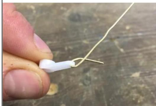
*Haga un hueco a un lado de la cara frontal y fije el otro extremo del clip. Cubra con cinta adhesiva o silicon para lograr mayor fijacion.*
